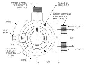
MAXIMUM BORE PENETRATION ON BLIND SHAFT IS 2.00"
