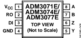
Figure 5. ADM3071E/ADM3074E/ADM3077E Pin Configuration
