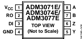
Figure 5. ADM3071E/ADM3074E/ADM3077E Pin Configuration
