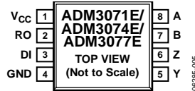
Figure 5. ADM3071E/ADM3074E/ADM3077E Pin Configuration
