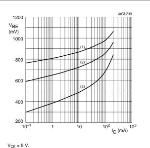
$V_{CE} = 3 \text{ V}.$ (1)  $T_{amb} = -55 \text{ °C}.$ (2)  $T_{amb} = 25 \text{ °C}.$ (3)  $T_{amb} = 150 \text{ °C}.$
