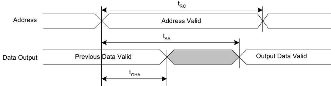
図 11. SRAM 読み出しサイクル 2:  $\overline{CE}$  および  $\overline{OE}$  制御 [27、29]
