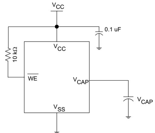
図 7 に、自動的な STORE 処理用のストレージ コンデンサ ( $V_{CAP}$ ) の適切な接続方法を示します。 $V_{CAP}$  の容量については、13 ページの DC 電気的特性を参照してください。 $V_{CAP}$  端子の電圧は、チップ上のレギュレータによって  $V_{V_{CAP}}$  に送られます。プルアップ抵抗は、電源投入の間、 $\overline{WE}$  をアクティブでない状態に保つために WE ラインに配置する必要があります。このプルアップ抵抗は電源投入している間、 $\overline{WE}$  信号がトライステート状態にある場合のみ有効です。nvSRAM がパワーアップ RECALL から復帰する時、ホスト マイクロコントローラが有効
