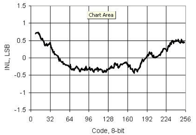
图 11-35. IDAC INL 与输入代码, 范围 = 255 \mu A, 灌电流模式
