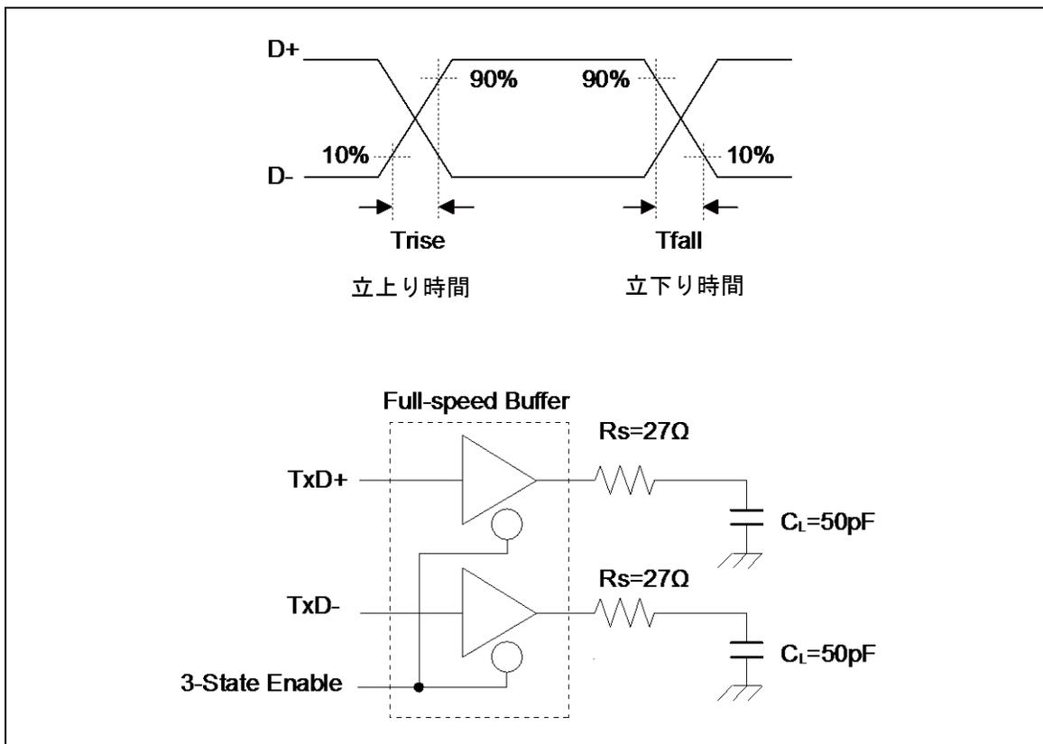
\*6: USB Full-speed 接続は、90  $\Omega \pm 15\%$ の特性インピーダンス(Differential Mode)で、シールドされたツイスト・ペアケーブルを介して行われます。USB 規格は、USB Driver の出力インピーダンスは 28  $\Omega$  ~ 44  $\Omega$  の範囲内になければならないことを規定しており、上記規格を満足し、バランスをとるために、ディスクリット直列抵抗器( $R_s$ )を付加することを規定しています。本 USB I/O をご使用の際には、直列抵抗  $R_s$  として 25  $\Omega$  ~ 30  $\Omega$  (推奨値 27  $\Omega$ )を付加しご使用ください。
