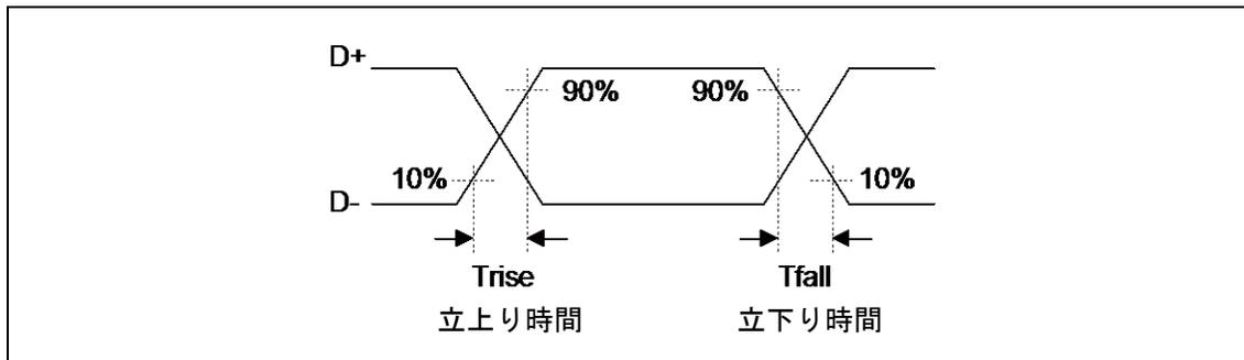
外部負荷条件は、「Low-Speed Load (Compliance Load)」を参照してください。
