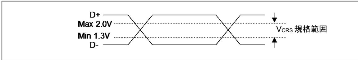
\*5: Full-Speed 差動データ信号の立上り( $T_{rise}$ )と立下り( $T_{fall}$ )時間規定です。出力信号電圧の 10% ~ 90%間の時間で定義されます。また Full-speed Buffer に関しては、 $T_r/T_f$  は、RFI 放射を最小にするために、 $T_r/T_f$  比を $\pm 10\%$ 以内と規定されています。
