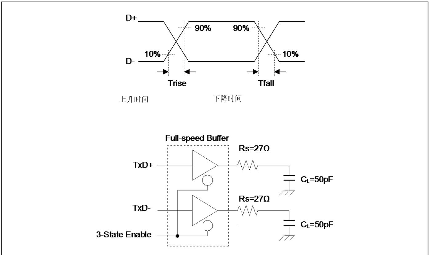
\*6:USB Full-speed 以  $90\Omega \pm 15\%$  的特性阻抗(Differential Mode), 通过屏蔽了的双股麻花缠绕电缆线。
