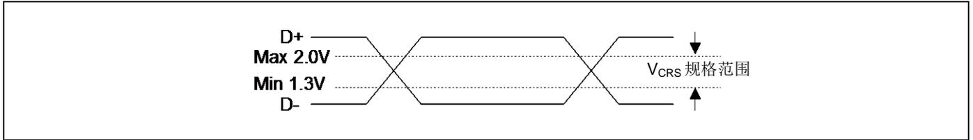
\*5:是 Full-Speed 差分数数据信号的上升( $T_{rise}$ )和下降( $T_{fall}$ )时间规定。
