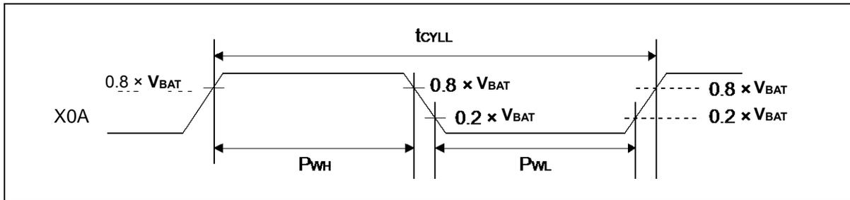
48pin パッケージの場合、V<sub>BAT</sub> は V<sub>CC</sub> と読み替えてください。
