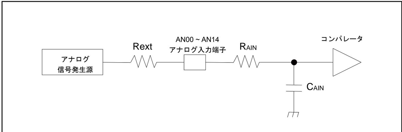
$$(式 1) T_s \geq (R_{AIN} + R_{ext}) \times C_{AIN} \times 9$$
