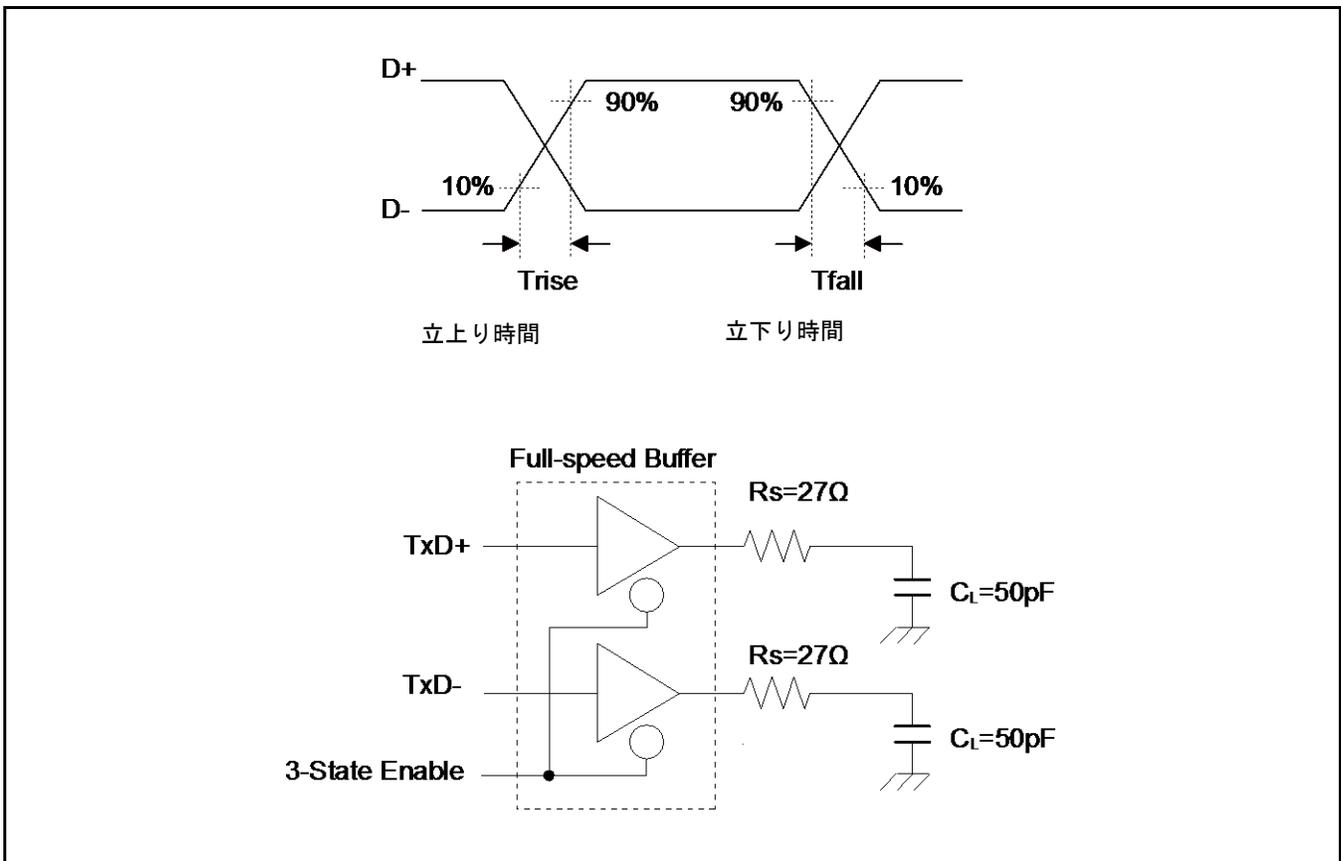
\*6: USB Full-speed 接続は、 $90\Omega \pm 15\%$ の特性インピーダンス(Differential Mode)で、シールドされたツイスト・ペアケーブルを介して行われます。
