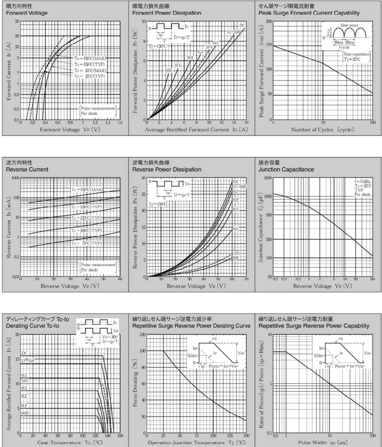
\* Sine waveは50Hzで測定しています。
