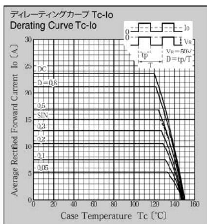
\* Sine waveは50Hzで測定しています。
