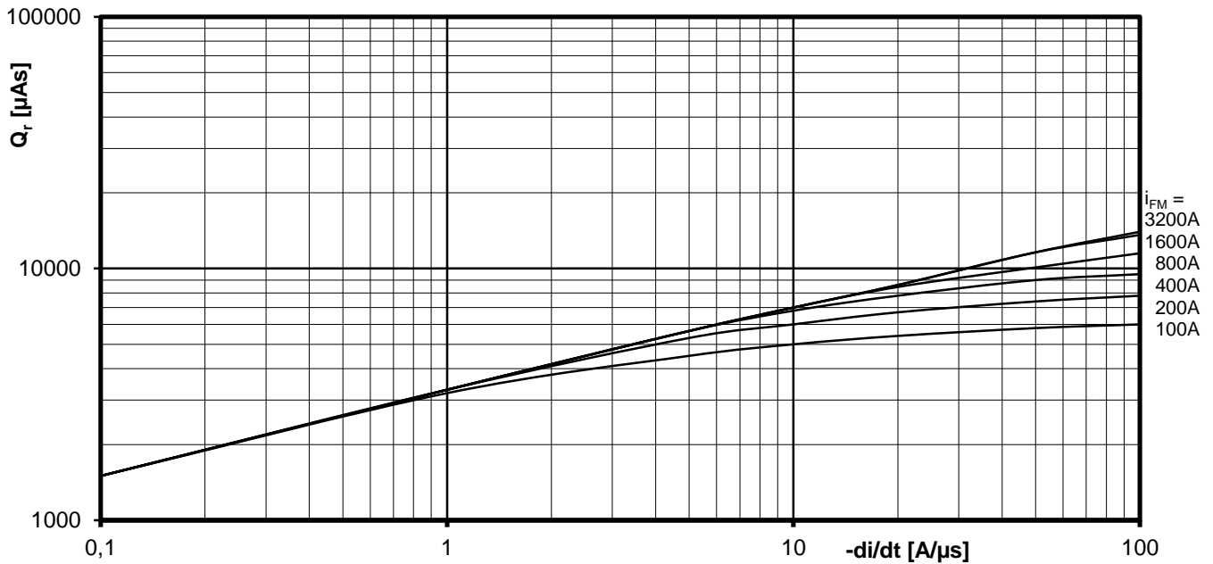
Sperrverzögerungsladung / Recovered charge Q_r = f(-di/dt)
