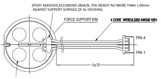
THE PUMP OF RUBBER SHOULD BE FREE FROM PRESS & SCRATCH. THE HIGHNESS NO MORE THAN 1.0mm AGAINST SUPPORT SURFACE OF AL HOUSING.
