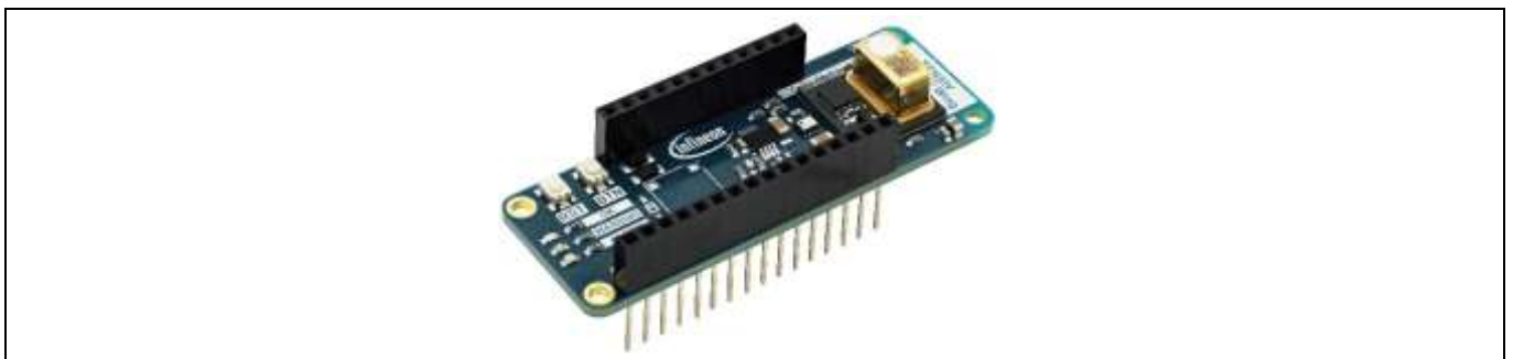
Figure 3 XENSIV™ PAS CO2 wing
