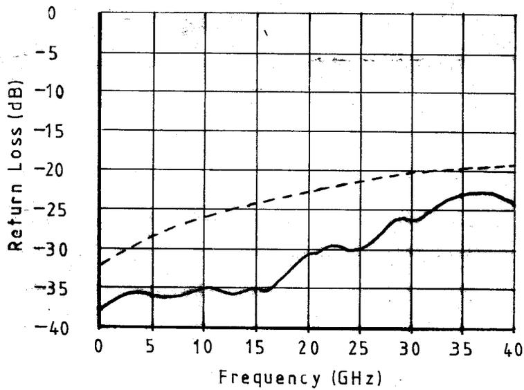
— . ROS . typique d'un connecteur SMA 2,9 montés sur cable semi-rigide de diamètre .085 et .116/.118
