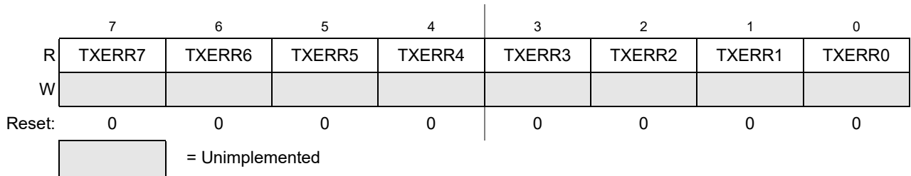
Figure 18-19. MSCAN Transmit Error Counter (CANTXERR)
