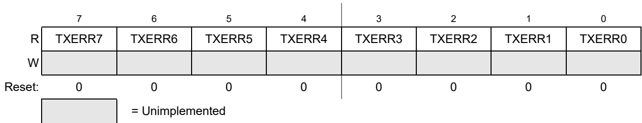
Figure 18-19. MSCAN Transmit Error Counter (CANTXERR)
