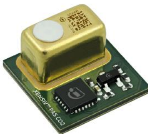
Figure 1 XENSIV™ PAS CO2 sensor
