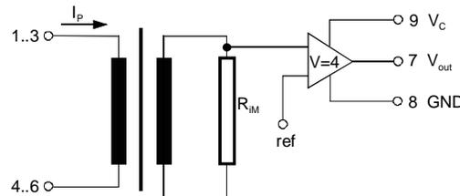
**Beschaltungsmöglichkeiten** (Werte bei  $T_A = 85^\circ C$ )
