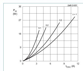
$$\begin{split} I_{F(AV)} &= I_{F(RMS)} \times \sqrt{\delta} \\ V_o &= 1.144 \text{ V; } R_s = 0.1272 \text{ } \Omega \end{split}$$
